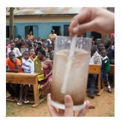
一緒に、その塊の中に一時的に取り込まれますが、殺菌力があるわけではないので、 汚れの塊を残せば菌は増殖します。この塊は、砂利や砂・布で簡単に濾し取ります。 そうした後、日本の水道水と同じように殺菌のための塩素を加えます。こうしてこ の浄化剤と簡単な設備で、直ぐに安全な水を作ることができます。(大阪の池の水 を浄化したものを試飲させて戴きましたが本当に無味無臭でした)
